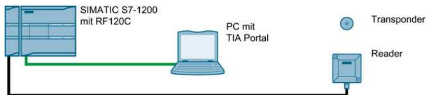
Bild 2-4 Integrationsbeispiel einer SIMATIC S7-1200 mit RF120C
